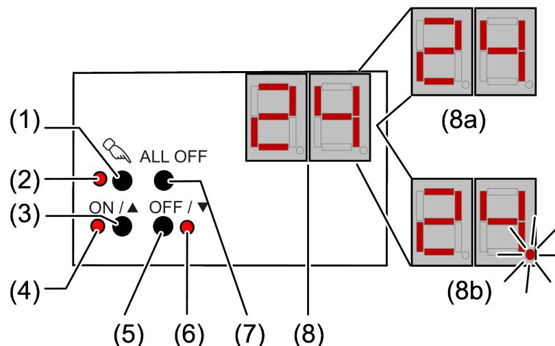
рисунок 1: Панель управления 1-канальным шлюзом DALI
