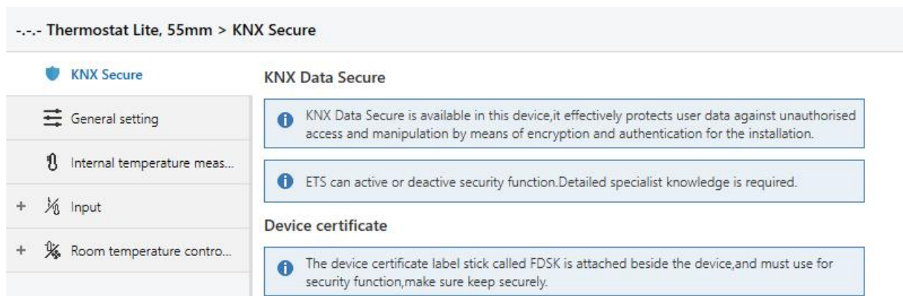
Fig.5.1 (1) "KNX Secure" parameter window
